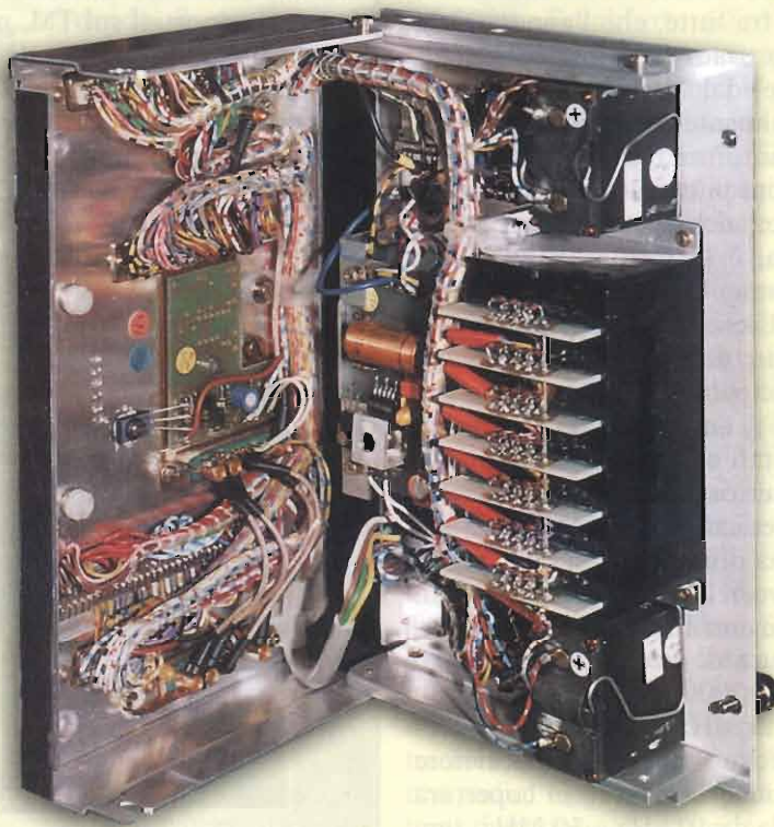
Sotto: Frontale del ricevitore aperto. Notare il retro dei contraves moltiplicati
